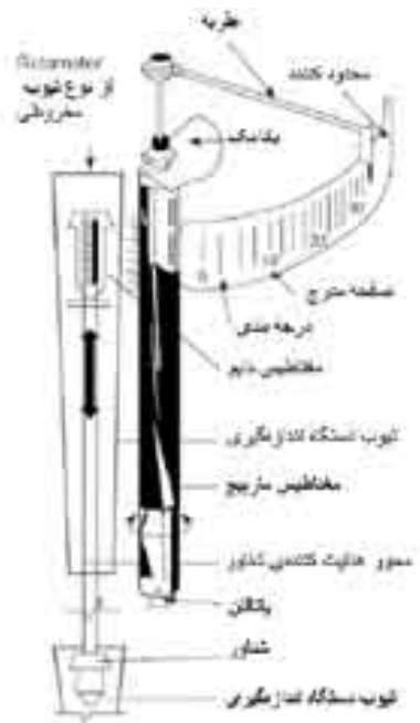
شکل ۲ - نقشه ی شماتیک یک نمونه از روتامتر و سازوکار نمایش جریان سیال
